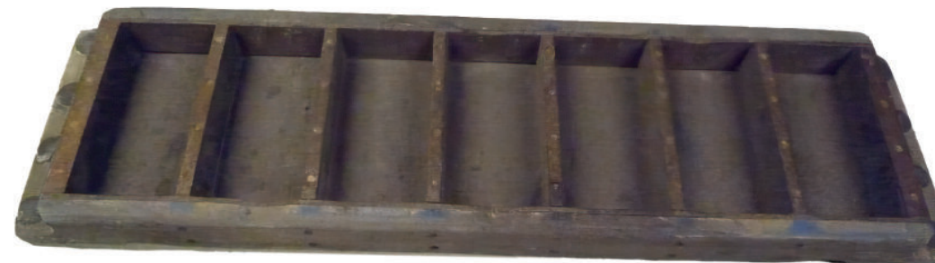
Baksteenmal voor zeven stenen
